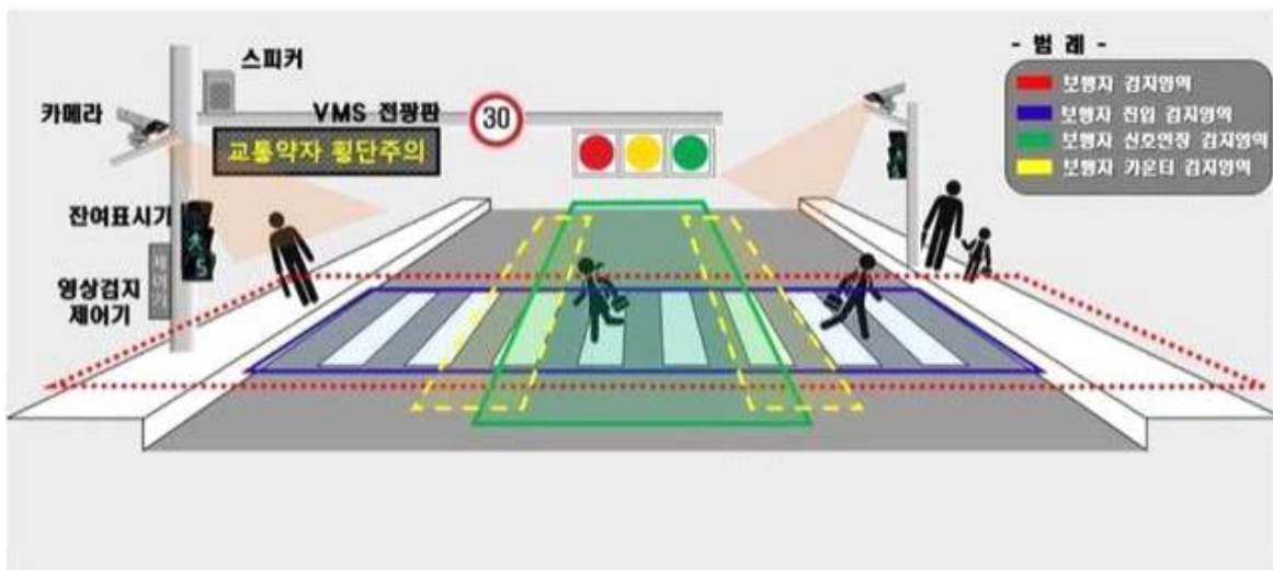
[그림 III-7] 보행신호 자동연장 시스템 개념도
