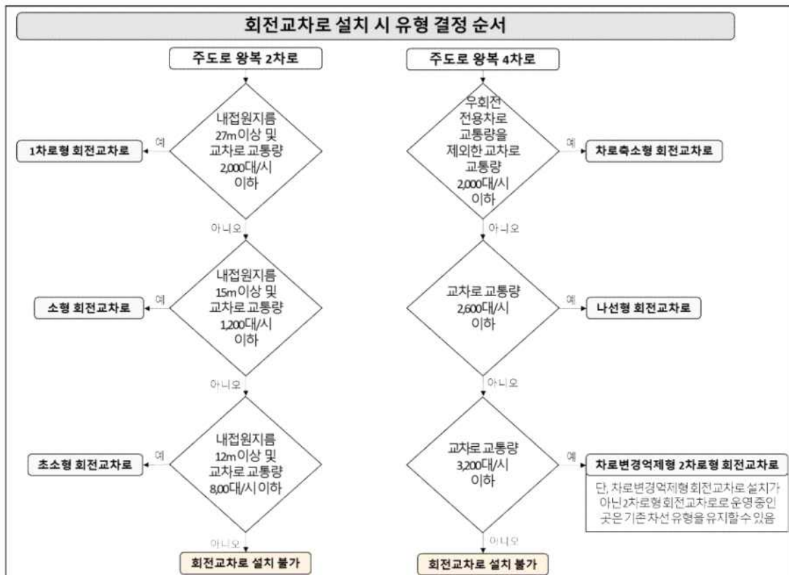
[그림 VI-7] 회전교차로 설치 시 유형 결정 순서
