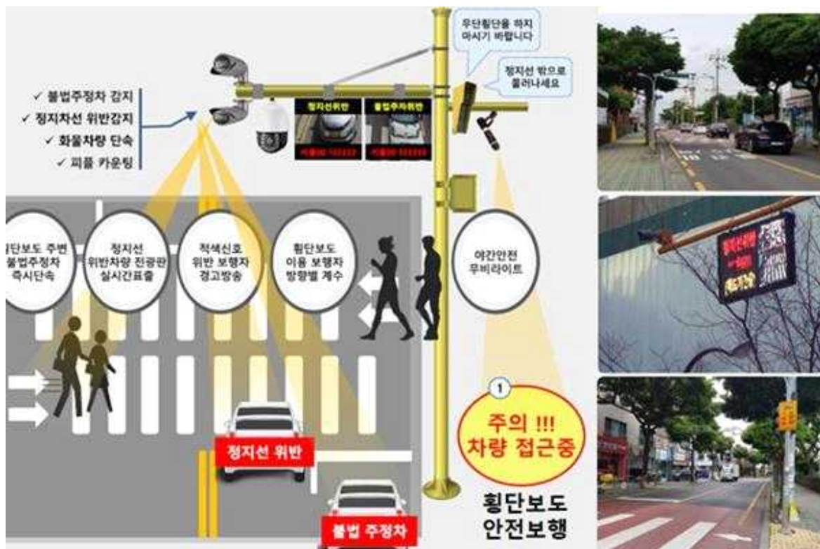
[그림 III-17] 제주시 제주시초등학교 과속·정지선·주정차위반 계도시스템
